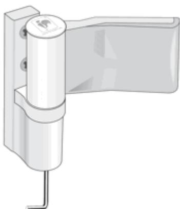
Регулировка дверных петель вниз и вверх выполняется посредством шестигранника. В нижней части рамной части петли находится регулировочный винт, вращая который можно регулировать створку в вертикальной плоскости.
